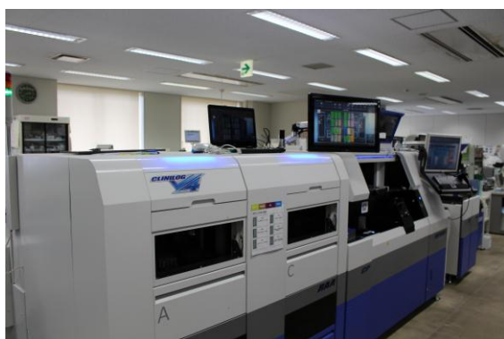
検体の投入・回収ライン
